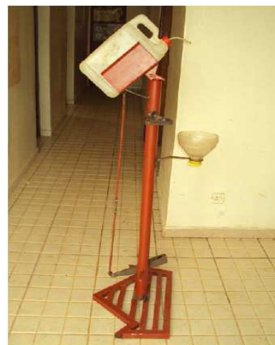
Dispositif de lavage des mains réalisé dans le cadre de USAID-PEPAM
