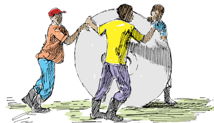
Figure 6. Les dalles circulaires peuvent être roulées pour être positionnées, ce qui les rend facile à déplacer sur des distances courtes
