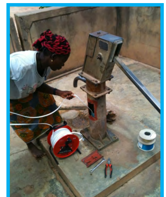
Suivi du niveau d'eau : une femme muni d'un enregistreur de données pour mesurer le niveau d'eau d'un forage.
