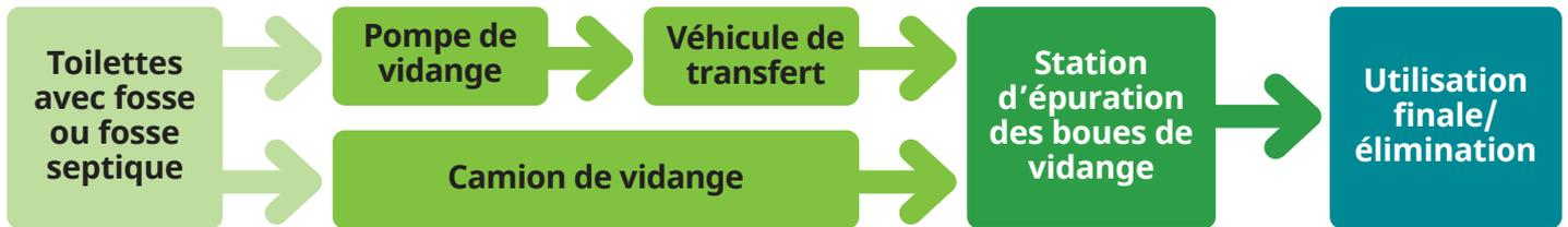
**D. L'assainissement en conteneurs (Container-Based Sanitation – CBS)**, au cours duquel un conteneur amovible reçoit les excréments et est régulièrement collecté et transporté vers une station d'épuration, puis remplacé par un conteneur vide. Ces conteneurs sont conçus pour être retirés régulièrement, contrairement aux fosses.
