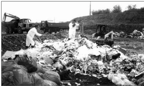
Photo 16 : Échantillonnage des déchets industriels sur une décharge en France (photo des auteurs)
