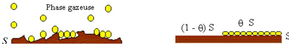
**Figure 17** : Illustration de l'interface gaz-solide et du recouvrement moléculaire d'une surface [77]
