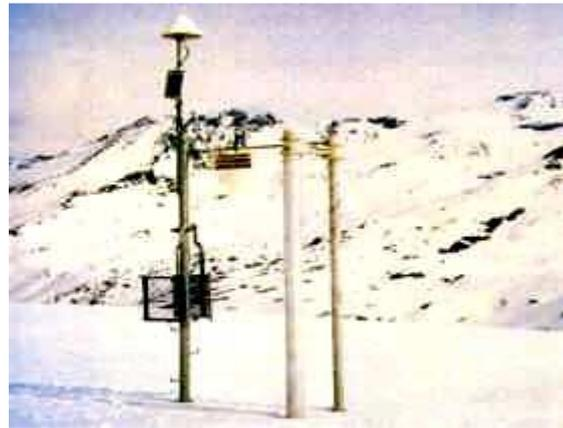
Tous les 10 cm, l'appareillage envoie une impulsion électrique ; le temps séparant deux impulsions mesure donc la densité de la neige sur 10 cm d'épaisseur. Lorsque l'émetteur émerge de la neige, le rayonnement reçu devient maximum et l'équipage mobile retourne à son point de départ. Le nombre d'impulsions permet donc de connaître l'épaisseur de la neige à 10 cm près au maximum.
