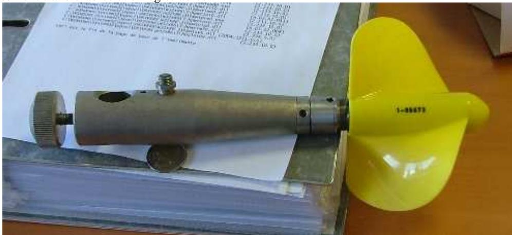
Le principe en est simple ; un axe auquel est fixée l'hélice est entraîné dans son mouvement de rotation. La partie arrière de cet axe porte, soit une vis sans fin qui par un système d'engrenage ferme un circuit électrique à chaque tour, soit un aimant dont la rotation provoque la fermeture d'un contacteur magnétique. L'axe du moulinet est porté par des paliers de haute précision à très faible frottement.
