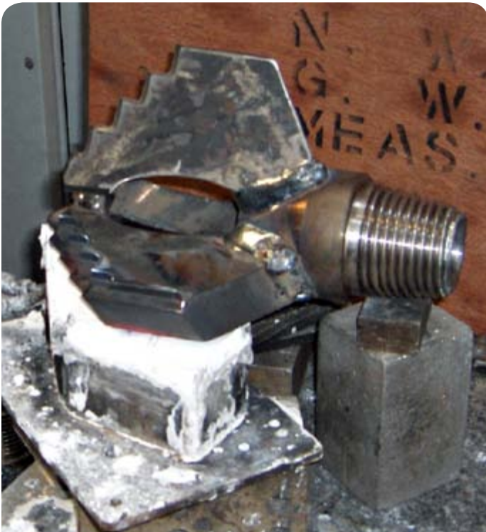
Fig. 2.66 Drag blade
