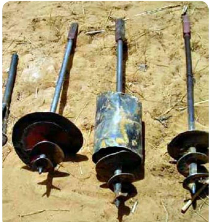
Fig. 2.15 Auger bits
