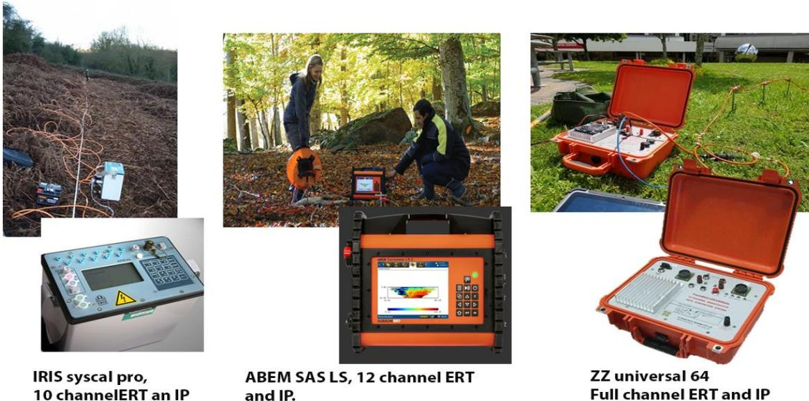
Figure 11, Instrumentation ERT de différentes marques
