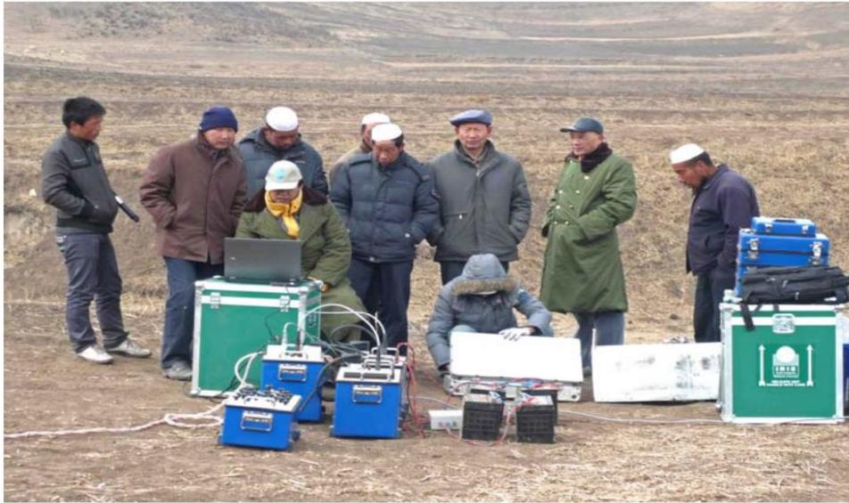
Figure 44, vue d'ensemble de l'équipement MRS dans une installation de mesure, IRIS NUMIS plus taille de la boucle d'instrumentation 150 m, 2 convertisseurs profondeur d'exploration d'environ 150 m (avec 1 convecteur la profondeur d'exploration est d'environ 100 m
