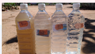
Figure 1: Echantillons d'eaux collectées lors du développement d'un forage
