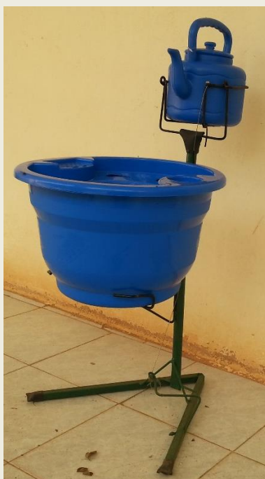
La bouilloire bascule lorsque le pied actionne la pédale
