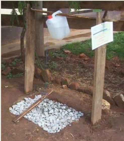
Drippy-tap : conserve ouverte sur sa partie supérieure et dont le fond est percé d'un petit trou. Utilisée pour puiser l'eau dans un réservoir. Une fois suspendue, l'eau verse permettant de se laver les mains pendant que la conserve se vide.
