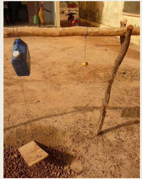
Tippy-tap : Bidon plastique de 4 litres ou plus, percé d'un trou sur sa partie supérieure, fermé par un bouchon également percé de petits trous, et suspendu à un bâton horizontal. Le bidon bascule quand la pédale est actionnée. Aire anti-bourbier.
