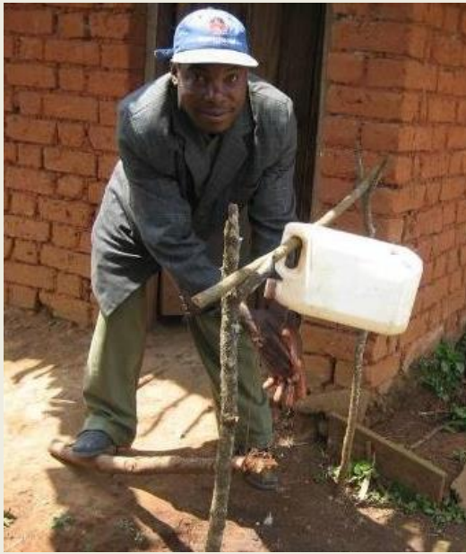
Tippy-tap : Bidon plastique de 4 litres ou plus, percé d'un trou sur sa partie supérieure, fermé par un bouchon également percé de petits trous, et suspendu à un bâton horizontal. Le bidon bascule quand la pédale est actionnée. Aire anti-bourbier.
