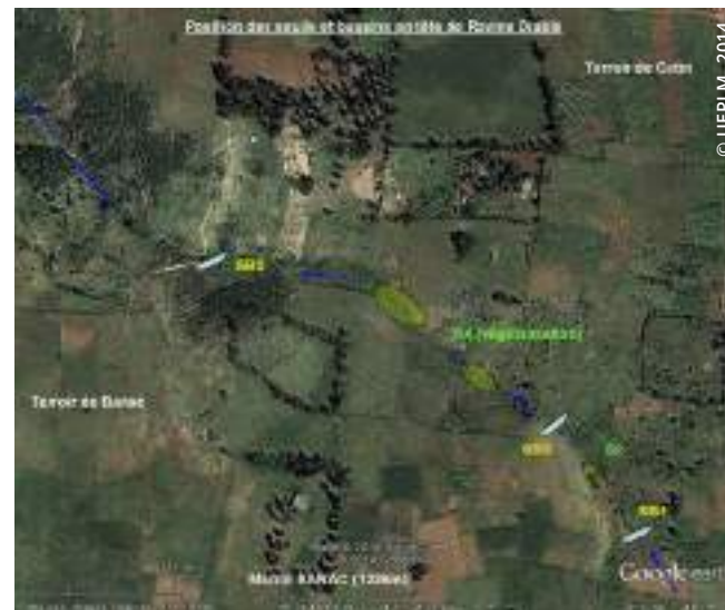
Complémentarité dans l'aménagement d'une ravine, ici la ravine Diable à Salagnac (Nippes), entre les seuils biologiques légendés en vert et les aménagements maçonnés légendés en jaune.
