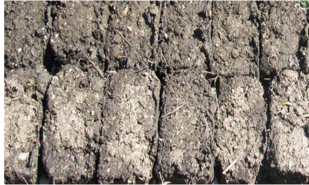
Figure 4.5 : Forme briquette des boues séchées
