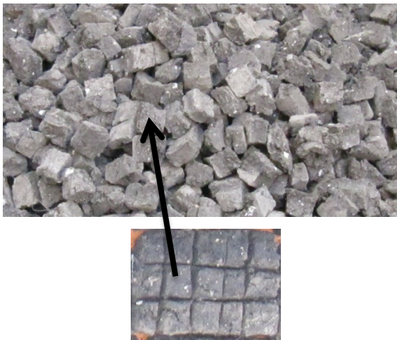
Figure 4.6: forme pellette des boues séchées
