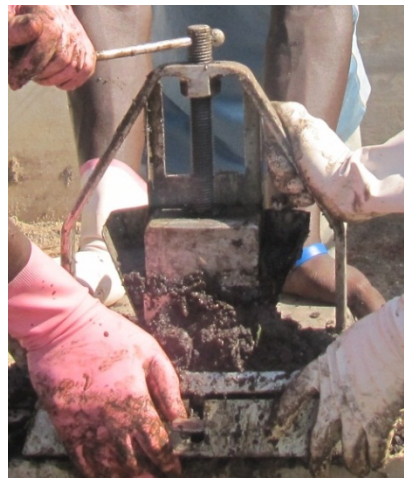
Figure 4.5 : Forme briquette des boues séchées
