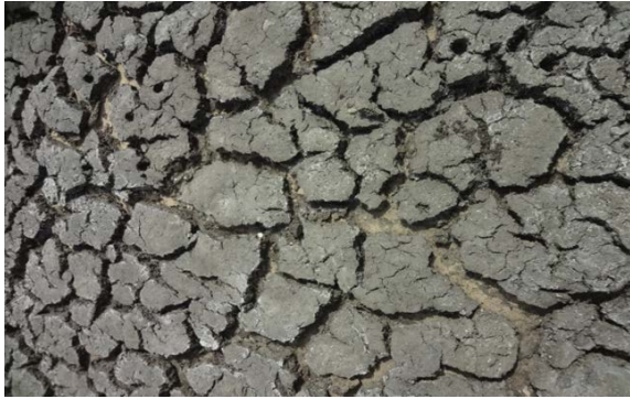
Figure 4.4 : forme gâteau des boues séchées
