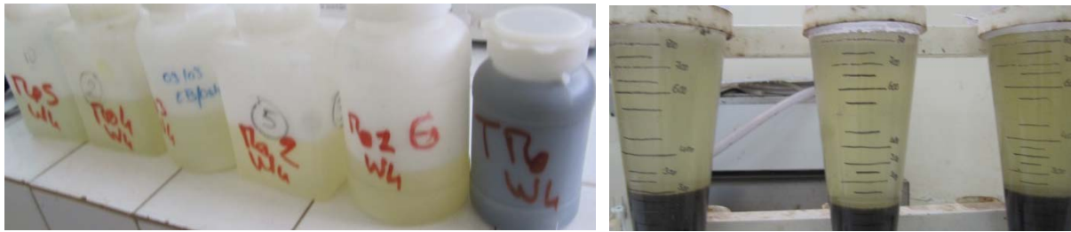
Figure 7.9 : Surnageant après décantation des boues conditionnées avec Moringa oleifera
