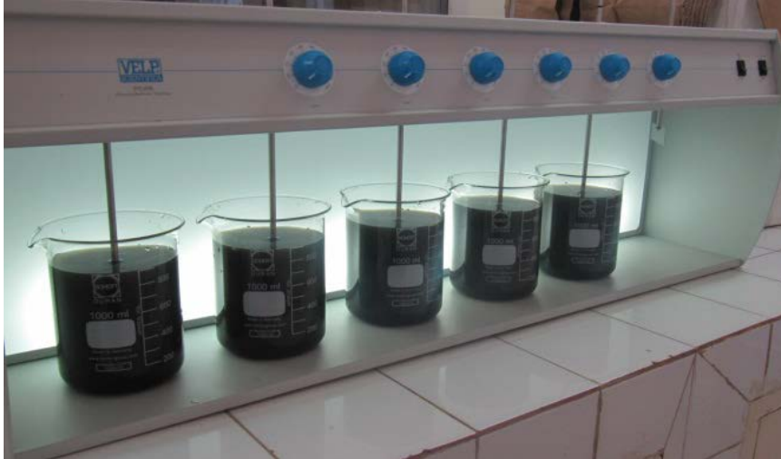
Figure 7.6 : Dispositif de coagulation/floculation : Jar test
