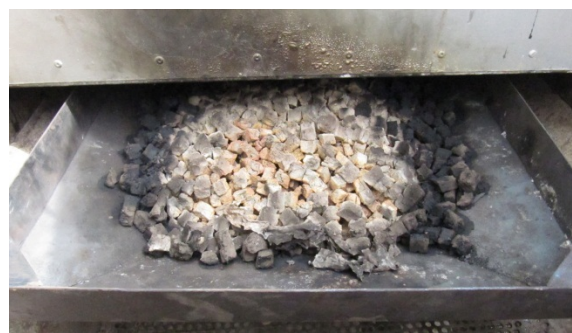
Figure 4.39 : Résidus de la combustion de Pellette
