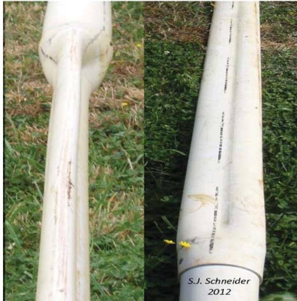
PVC effondré à cause de la chaleur excessive. Le PVC perd rapidement sa résistance lorsque la température augmente (voir figure 10, page 29).
