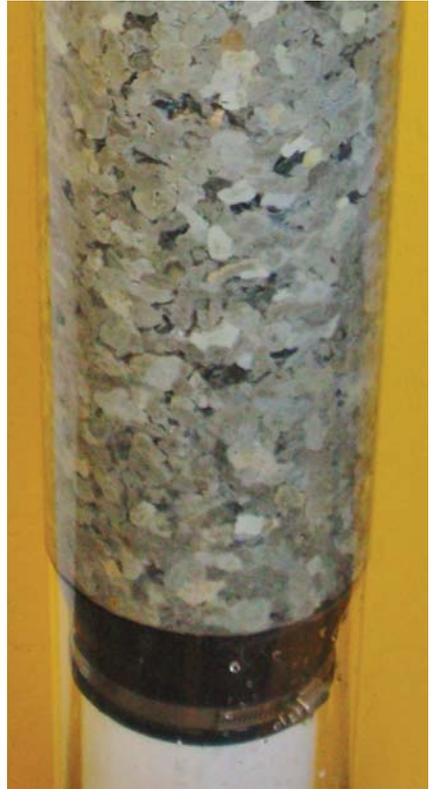
Gravillons de bentonite avant (à gauche) et après (à droite) hydratation initiale. Les gravillons de bentonite sont placés autour d'un tuyau blanc en PVC positionnés dans un tube en plastique transparent (pour une démonstration). Les gravillons sont retenus à l'aide d'un "shale trap".
