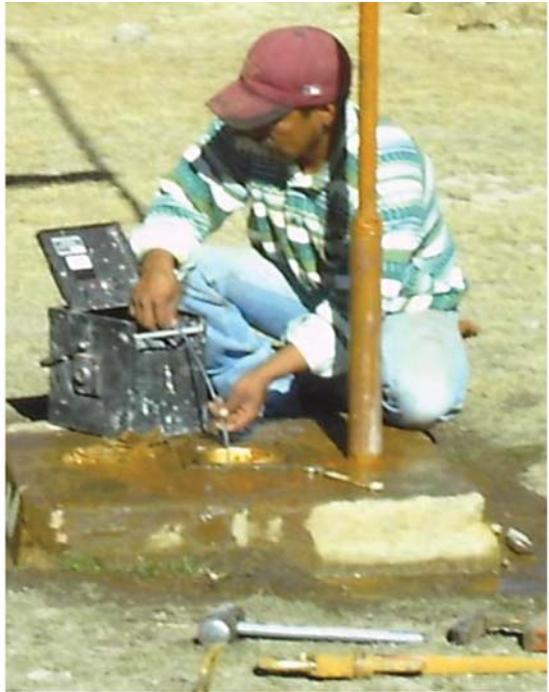
Mesure du niveau statique avec une sonde électrique
