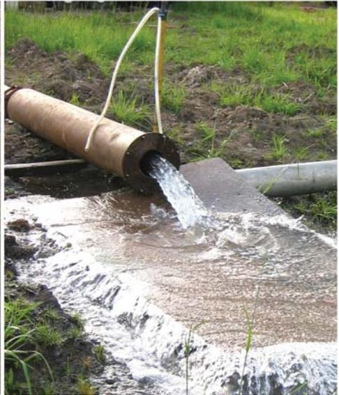
Mesure du débit d'un tube d'orifice de puits municipal
