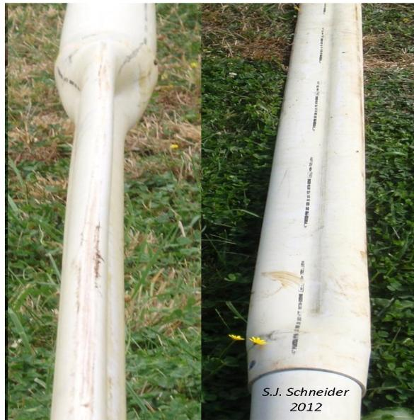
El PVC colapsó a causa del calor excesivo.
