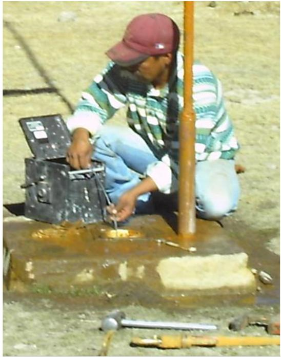
Medición SWL con sonda eléctrica
