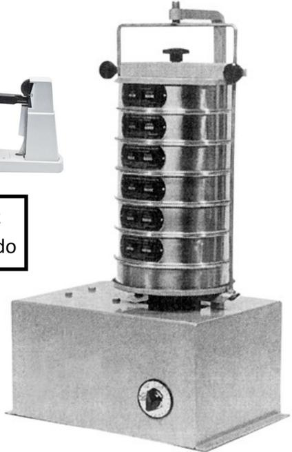
2. Realizar un análisis granulométrico (ver figura 13, página 50) en cada uno de los WBZ seleccionados que puedan ser visualmente identificados para tener potencialmente el material más fino. Un análisis granulométrico no se realizara en cada muestra tomada.
