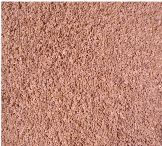
7. Seleccione una abertura de entrada del pozo (anchura de ranura) que no sea más grande que el tamaño retenido del 90% del material de paquete de filtro seleccionado.
