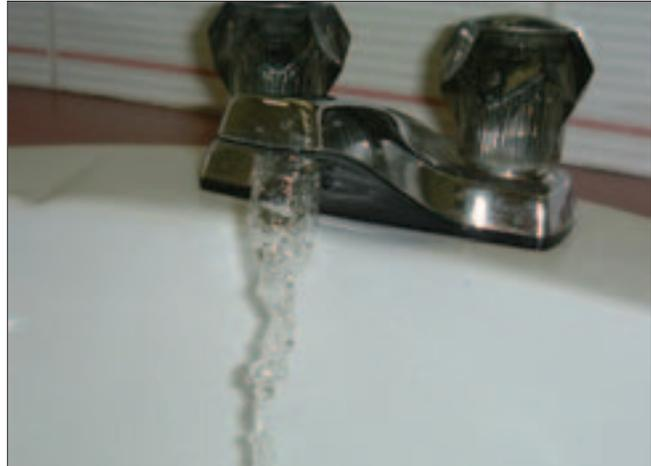
6. Réduire le débit avant de prélever l'échantillon. Laisser couler l'eau assez lentement de manière qu'il n'y ait aucun éclaboussement lors du remplissage de la bouteille. Ne pas ajuster le débit lorsque l'on prélève un échantillon à un endroit où l'eau coule en permanence.
