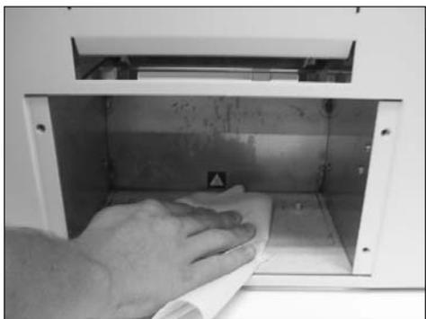
**4** Utilisez un détergent doux, de l'eau de Javel diluée ou de l'alcool isopropylique pour nettoyer toutes les surfaces accessibles à l'intérieur du sealer et l'ensemble du rouleau inférieur.
