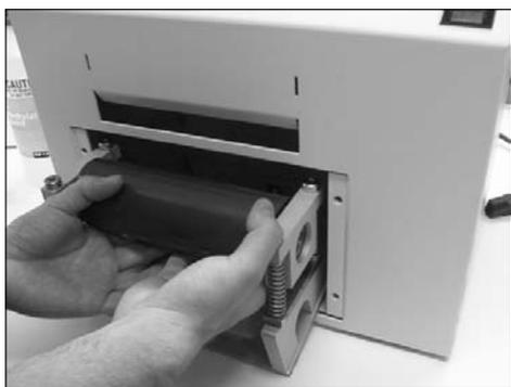
**5** Réinstallez l'ensemble du rouleau inférieur sur les goujons d'assemblage et serrez les vis de retenue.
