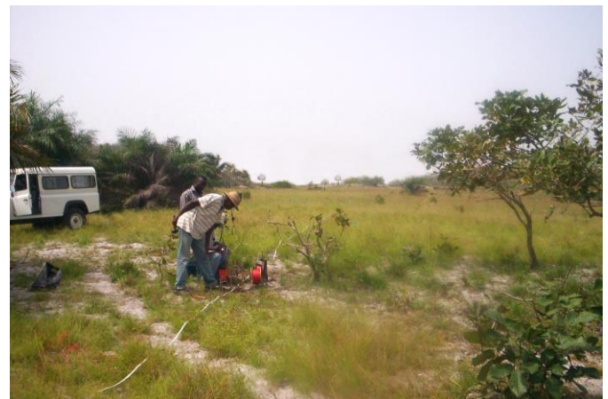
Figure 8: Sondage électrique vertical au Nigéria
