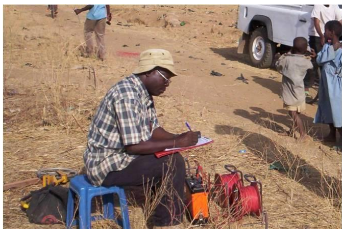
Figure 9: Sondage électrique vertical au Nigéria
