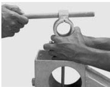
7) Retirer la tige supérieure et insérer l'outil d'arrêt en dessous de la connexion des tiges.
