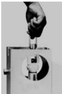
1) Insérer l'ensemble constituant le clapet de pieds dans le tuyau d'exhaure et laisser tomber.
