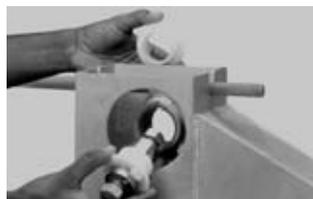
5) Insérer l'arbre de transmission et ses paliers dans la chaise de transmission.
