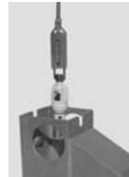
10) Remplacer la tige de piston avec l'outil-pêcheur et réintégrer toutes les tiges de pompe pour repêcher le clapet de pied.
