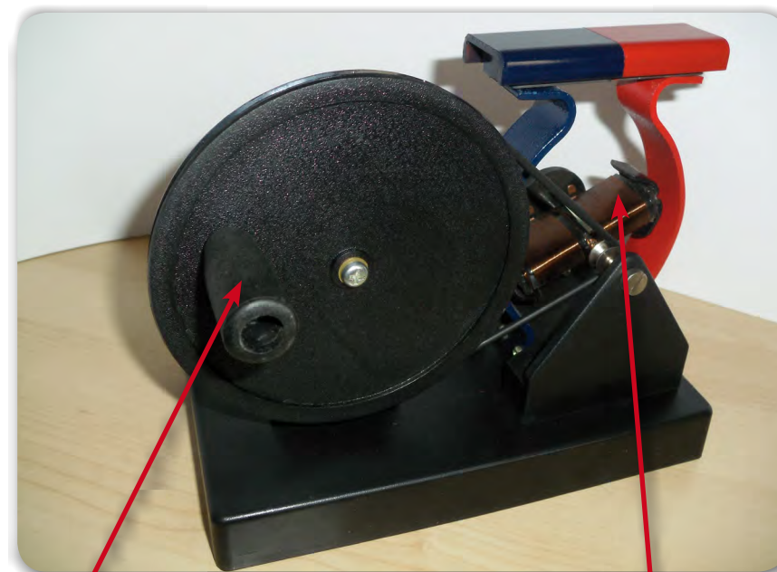
Manivelle permettant de mettre en rotation la bobine par l'intermédiaire d'une courroie
