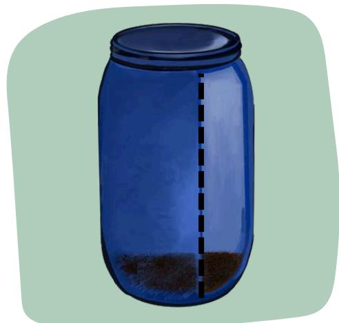
Placez un baril vide sous le trou de la cuvette. Recouvrez le fond du baril d'un mélange de terre sèche et de cendres.
