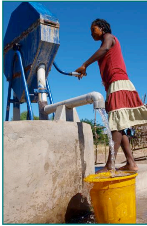
Rope Pump équipant un puits (©pS-Eau)
