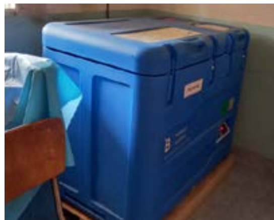
Figure 26 : Réfrigérateur pour maintenir les vaccins à une température adéquate
