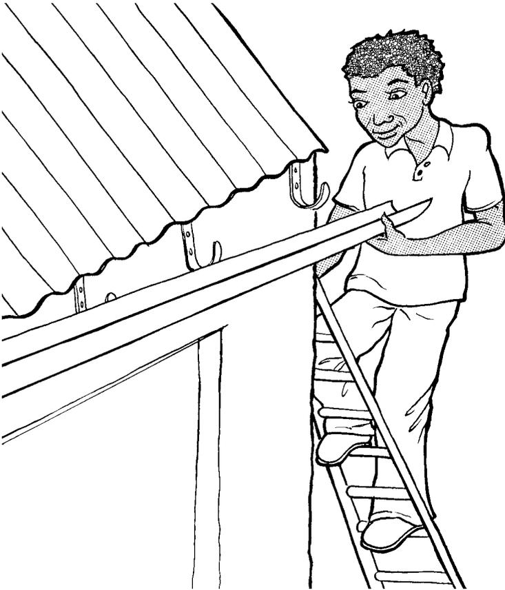
Figure 4 : Installation d'un système de gouttières
