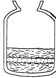
Soyez sur que le foin soit bien entasse dans le digesteur. En faisant cela, il sera possible d'empiler plus de foin dans le digesteur et donc d'obtenir plus de gaz.
