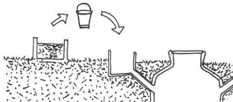
1. Les déchets des animaux et l'eau peuvent être mélangés dans une proportion de 1:1 et déposés dans le digesteur (un seau d'eau pour un seau de bouse)
