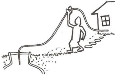
b). Quand le tuyau qui transporte le gaz n'est pas enterré sous la terre, vous pouvez le soulever vers le digesteur et laisser l'eau couler a l'intérieur du digesteur.
