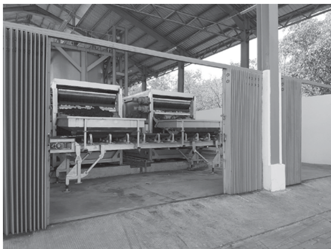
Photo 7.4 Filtre à bande dans la station de traitement des boues de Duri Suwung à Denpasar en Indonésie
