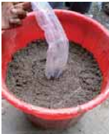
Effondrement du 'trou de forage' (seau)
