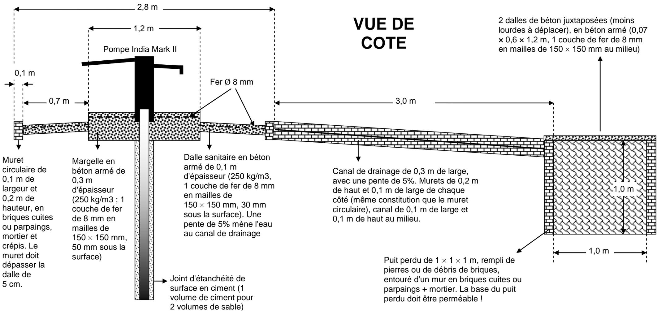
**Remarque :** Un béton de 250 kg/m<sup>3</sup> est composé d'un volume de ciment pour 2 volumes de sable et 4 volumes de gravier.
