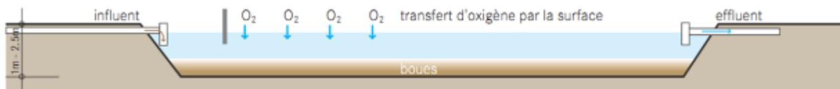
Figure 10. Schéma de fonctionnement d'un bassin de lagunage aérobie (selon v)
