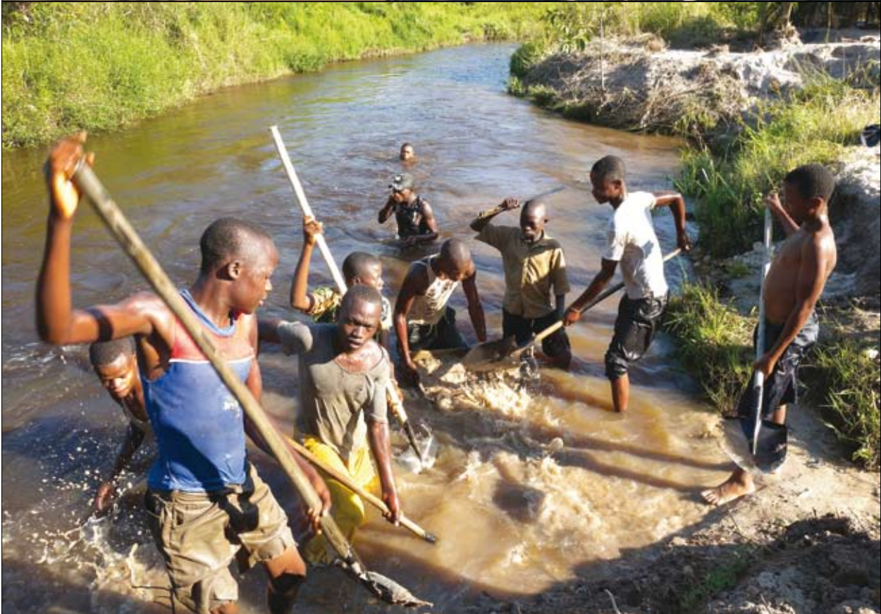
Le long de la rivière Chibungu dans le Kasai-Occidental, l'exploitation des gisements alluviaux de diamants qui comporte le défrichage des végétations et le lessivage du gravier, ce qui a pour effet d'augmenter la turbidité et la sédimentation
