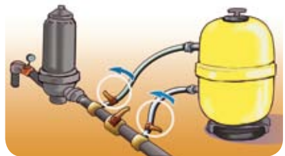
Ouvrir les deux vannes de sectionnement
