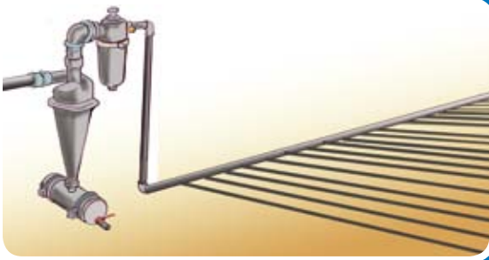
Réseau d'irrigation goutte à goutte
