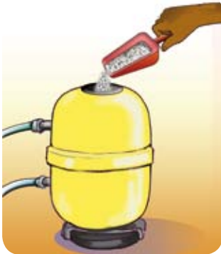
Remplir l'engrais hydro-soluble dans le tank pour mélange
