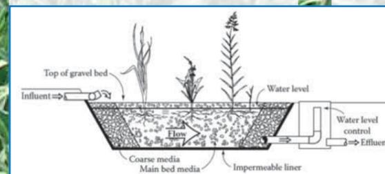
Figure 2 : Filtre planté à flux horizontal
