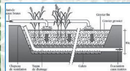
Figure 3 : Schéma d'un filtre planté à flux vertical
