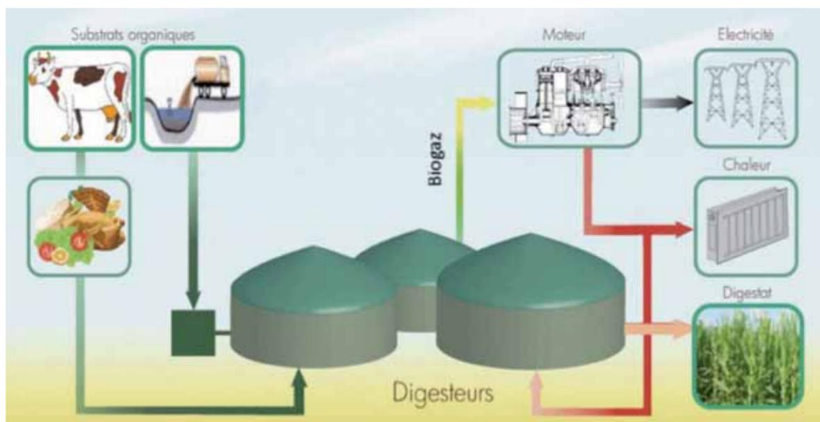
Figure 1 : schéma de principe d'une unité de biogaz
