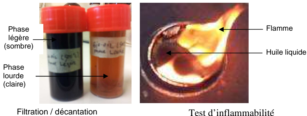
Figure 3. Comportement des huiles de pyrolyse : Séparation en deux phases et test d'inflammabilité
