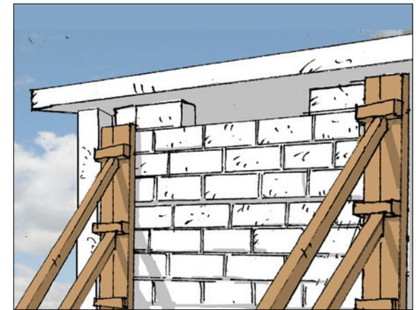
11. Pour la dernière rangée de blocs, mettre les deux blocs extrêmes dans les coins supérieurs du mur. Placer le reste des blocs en dernier lieu. Attendre 2 jours avant l'application de l'enduit.
