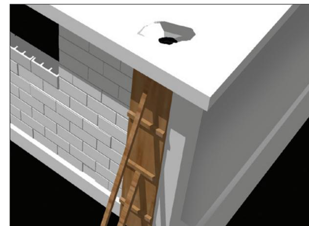
**6.** Percer un trou dans la dalle au droit de l'armature verticale. Lier la barre verticale et le plancher avec une autre barre d'armature de 60 cm [24 pouces] de long en la scellant dans le trou avec du mortier.
