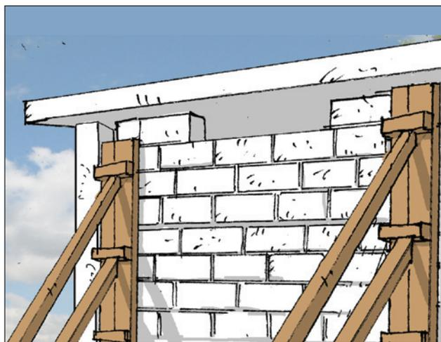
**9.** Pour la dernière rangée de blocs, mettre les deux blocs dans les coins et placer le reste des blocs ensuite.
