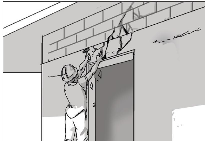
**2.** Retirer avec précaution les éléments d'enduit et de maçonnerie endommagés. Enlever le linteau au complet.
