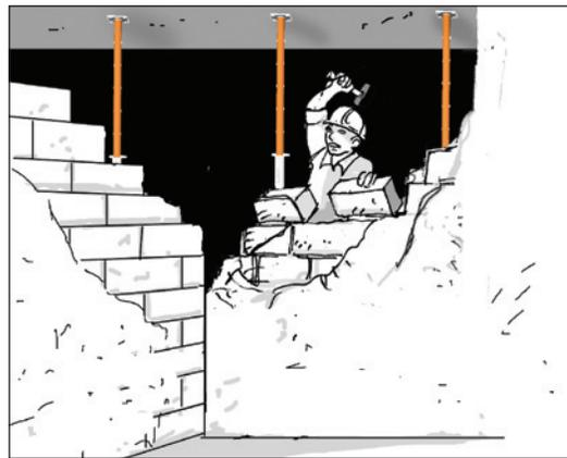
**2.** Retirer le mur existant avec soin et éviter d'endommager les colonnes voisines. Enlever avec précaution les éléments de maçonnerie et d'enduit endommagés du plafond de la toiture, du plancher, des angles et/ou des colonnes.
