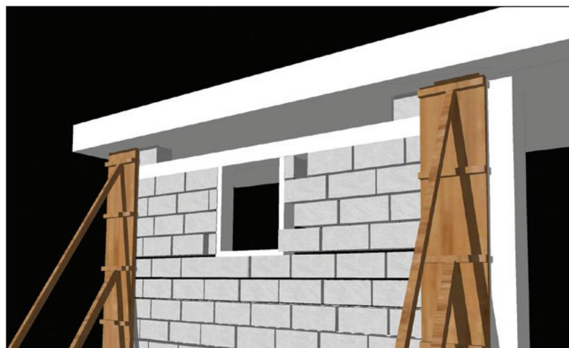
**9.** Pour la dernière rangée de blocs, mettre les deux blocs dans les coins et placer le reste des blocs ensuite.
