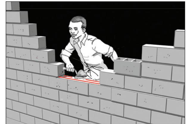
**3.** Poser un mortier de 1.3 cm [0.5 pouces] d'épaisseur maximum et installer une première rangée de blocs. Entrecroiser les blocs aux angles.
