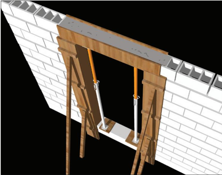
**4.** Mettre le béton du linteau et des éléments verticaux en place. Laisser durcir pendant une journée avant de poursuivre avec la maçonnerie.
