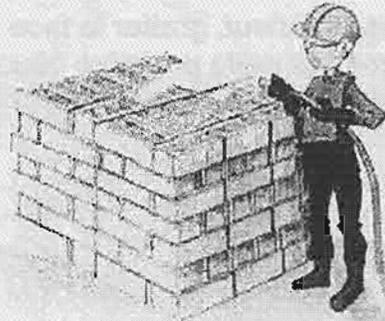
La face supérieure de chaque chaînage doit être au niveau.
