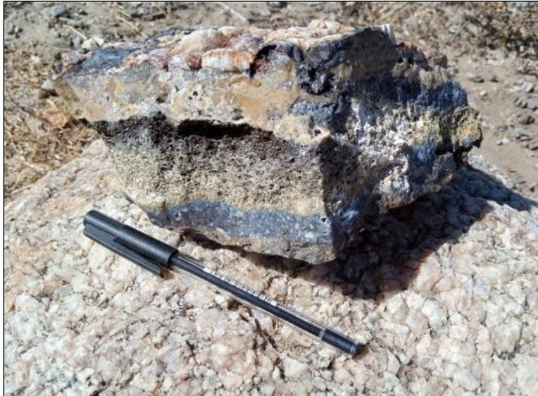
Figure 29: Quartzite altérée avec veines d'Oxyde de Fer à Anzamani
