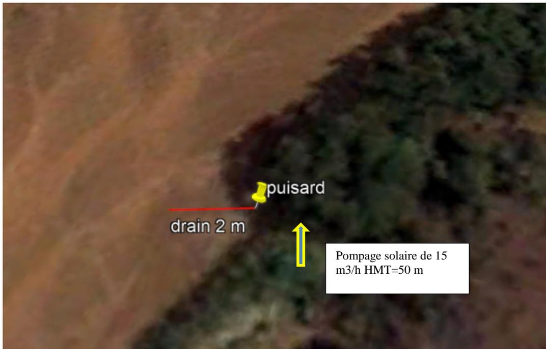
Figure 16. Schéma du système de captage et de pompage d'eau potable pour la localité de Mahaboboka sur google earth
