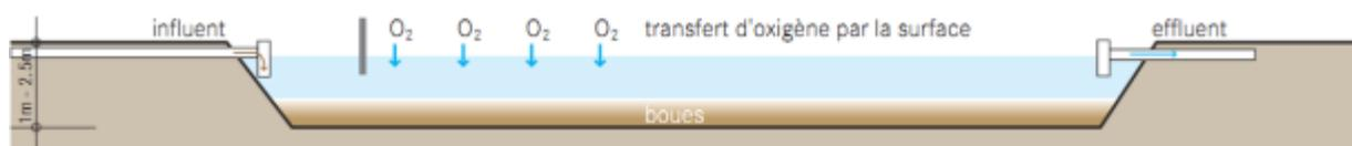
Figure 4. Schéma de fonctionnement d'un bassin de lagunage aérobie
