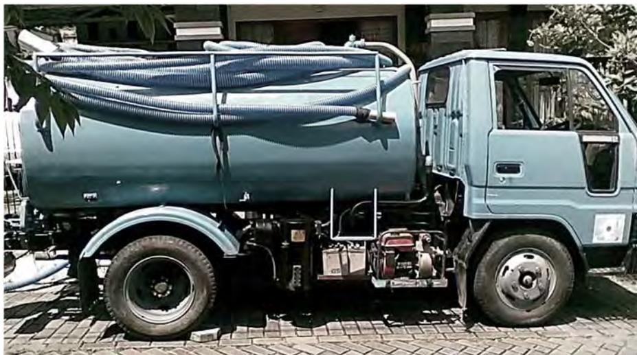
*Bagian-bagian penting dari suatu unit sedot tinja adalah tangki, pompa dan selang lumpur tinja. Baik gerobak motor roda tiga, mobil pick-up maupun truk, ketiga komponen tersebut harus ada.*
