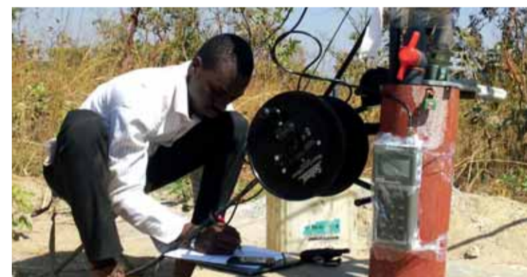
Suivi d'un pompage d'essai par un doctorant béninois du projet GRIBA.
