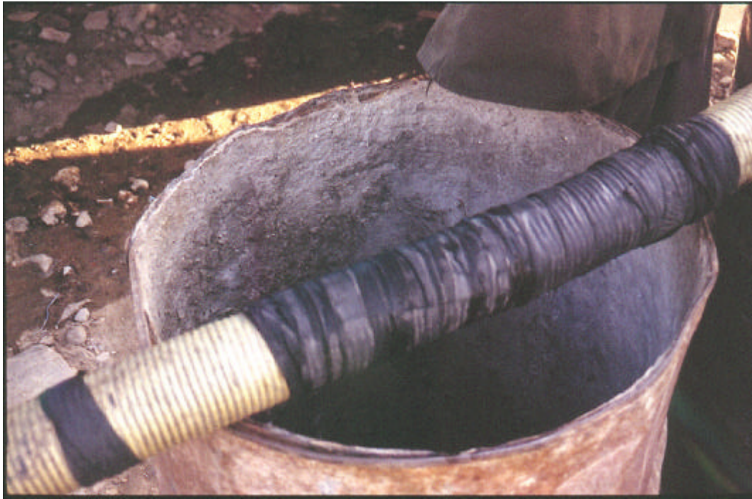
Photo. 13 : Fût de stockage d'eau enduit d'une couche de ciment
