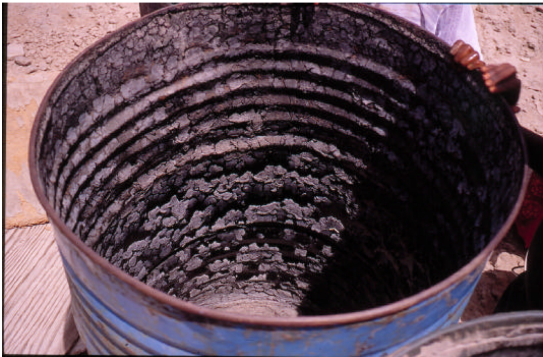
Photo. 14 : Fût enduit d'une couche de goudron contre la rouille
