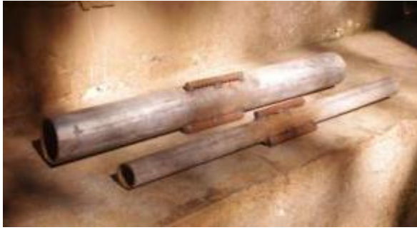
Photo 65 : Tuyau avec fer soudé pour améliorer l'ancrage
