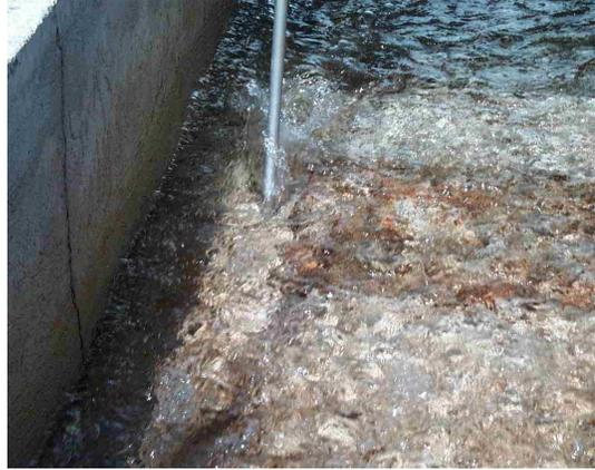
FIGURE 4.10 – Régime torrentiel : les ondes ne remontent pas le courant ; on peut en revanche avoir une estimation de la vitesse en mesurant la hauteur de la remontée du niveau d'eau sur l'obstacle :  $\delta h = U^2/2g$
