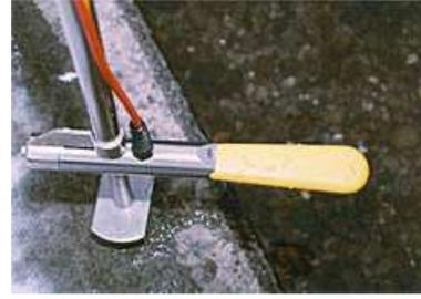
FIGURE 6.4 – Courantomètre électromagnétique (photo OTT)
