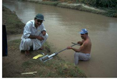
FIGURE 6.14 – Prélèvement d'une carotte de sédiments fins
