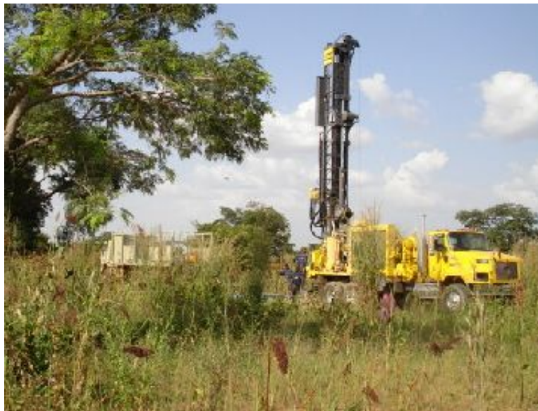
Illustration 20: Foreuse au Burkina Faso (source Les amis du Burkina)
