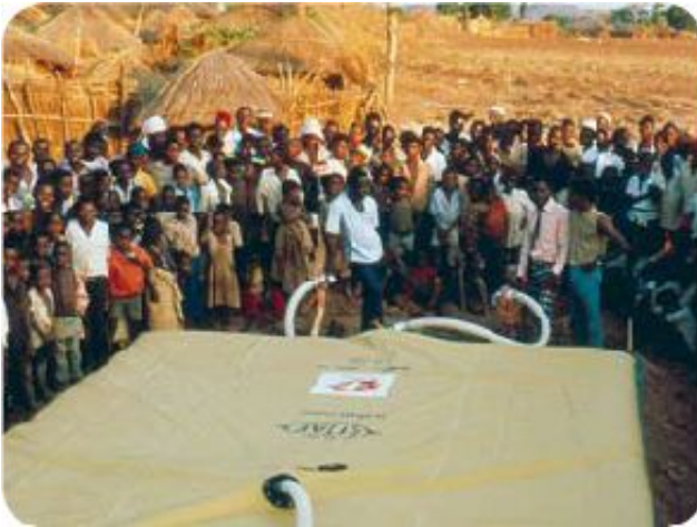
Illustration 16: Citerne souple pour l'alimentation en eau en situation d'urgence (source CITAF)
