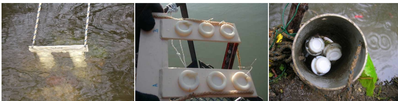
Figure 38. Dispositifs DGT installés en rivière (Gourlay-Francé, 2009)
