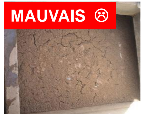
Filtre rempli de sable 0,9-1,2 mm et gravier 20-30 mm
