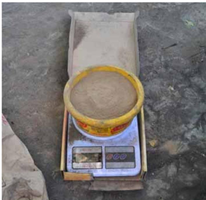
**15. Argile broyé/tamisé et pesé à l'aide d'une balance à plateau numérique**
