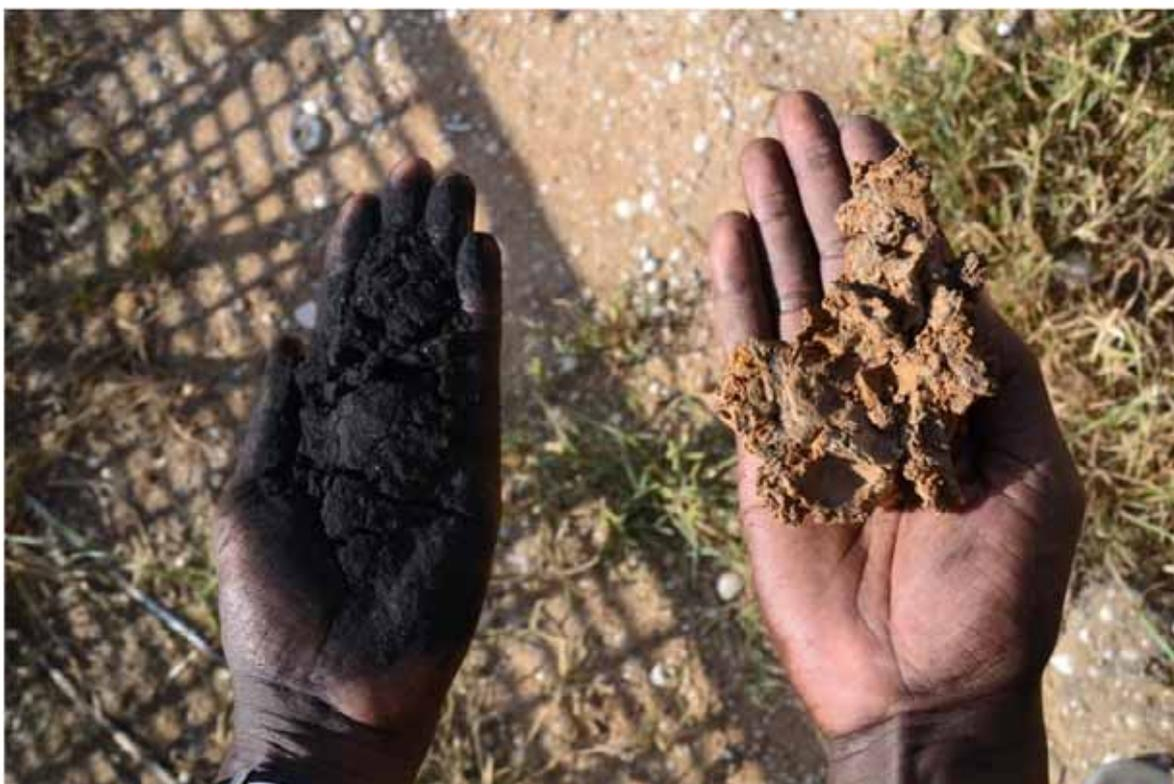
**14. Poudre de Typha carbonisé (à gauche) et argile brut (à droite)**
