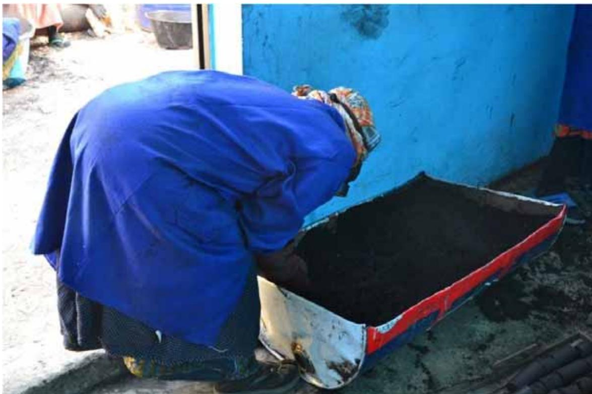
**16. Mélange homogène prêt à être briqueté**
