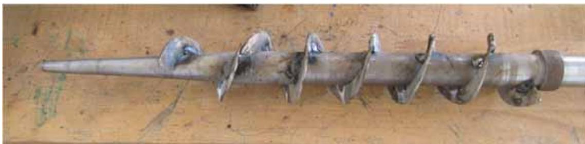
31. Partie hélicoïdale de la vis à extrusion
