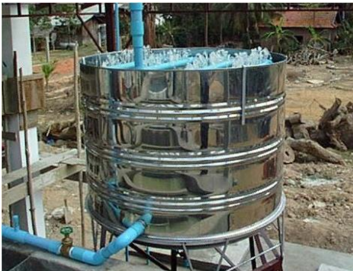
Figure 13 – Système d'aération d'une eau (source : Gret Cambodge)
