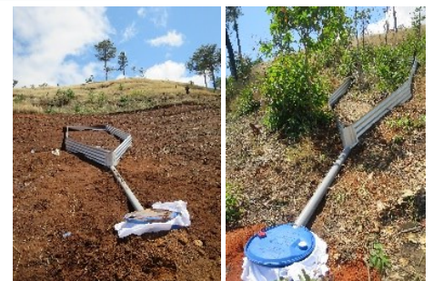
Dispositif de suivi de l'érosion (© Etc Terra)
